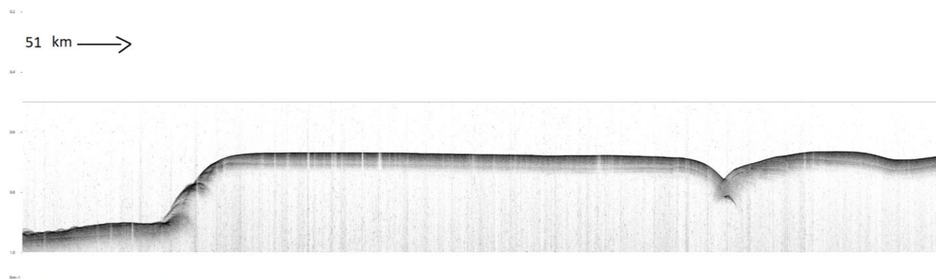
figura 1: Imagem retirada do programa MERIDATA SVIEW na cabeceira do cânion, a região elevada possui caráter de eco tipo 2A.
